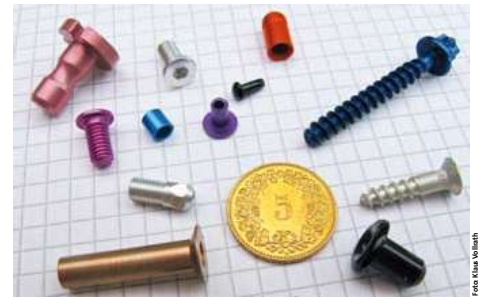
Eine Auswahl von Bauteilen, die sich gut für das Trommelanodisieren eignen
